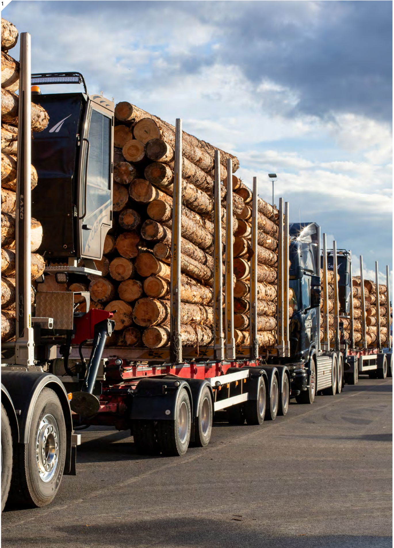
1 Det første tommervogntoget er 74 tonn og det bakerste 60 tonn i totalvekt. Vi ser forskjellen på stakehøyden på bilene, hvor 74-tonns vogntoget har fylt opp stakene, mens det på 60-tonns vogntoget er plass igjen. 74-tonn testes for tiden på et begrenset antall veier i Innlandet.
